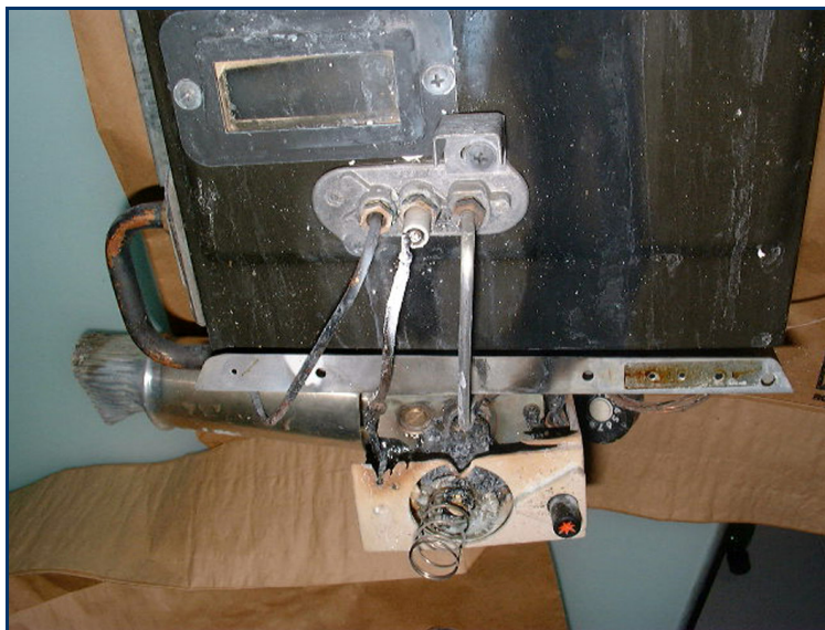
Fig. 3-27 Vue du système de régulation défectueux calciné
