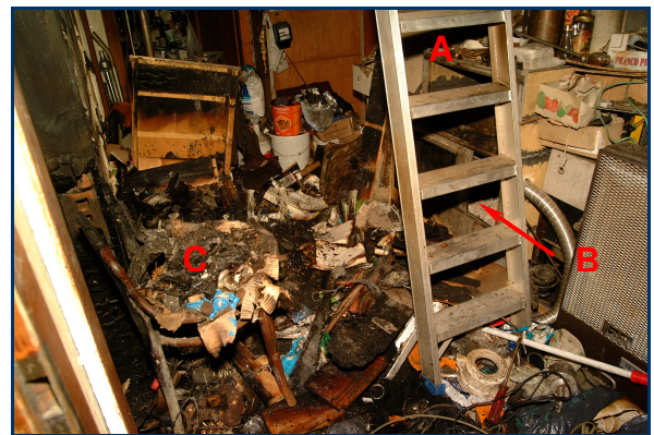
Fig. 3-24 Vue du système de chauffage (A), du foyer laissé entrouvert (B) et de la chaise qui supportait les journaux et les cartons (C)
