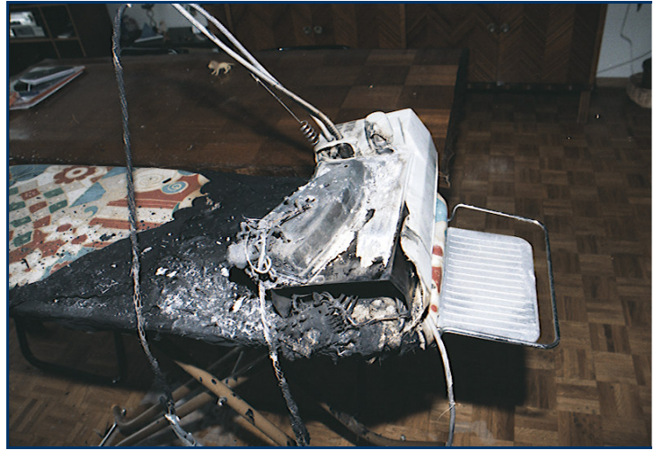
Fig. 3-35 Vue de détail du fer mal repositionné par la locataire sur le socle
