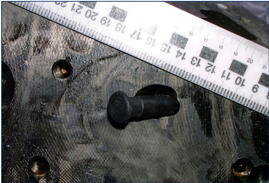
Fig. 3-48 Reste de la mèche en acier endommagée. L'extrémité brisée a fondu suite au frottement contre l'autre partie de la mèche montée sur le bras mobile de la machine.
