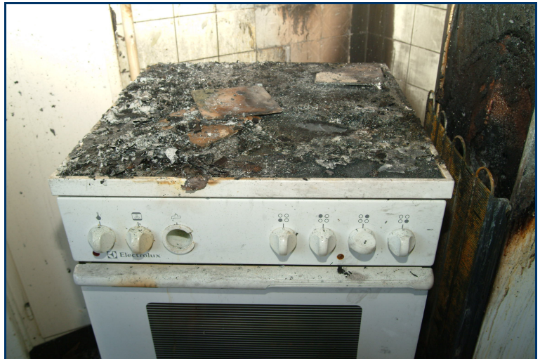
Fig. 3-33 Détail des interrupteurs des plaques de cuisson. Celui qui contrôle la plaque au fond à droite se trouve sur la position 8
