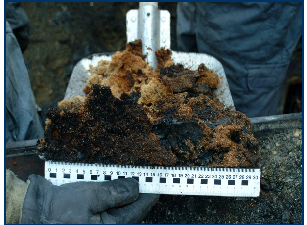
Fig. 2-36 Détail des calcinations dans les couches profondes du tas de sciure
