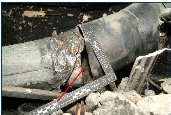
Fig. 3-6 Détail de l'interstice visible avant le coude du tuyau de raccordement, masqué avec de la feuille d'aluminium
