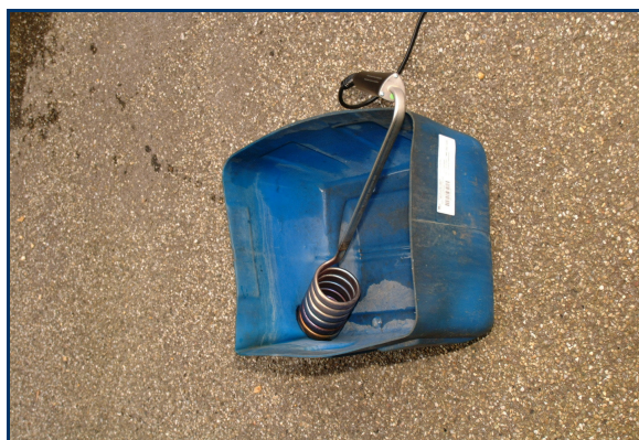
Fig. 3-37 Reconstitution et expérimentation avec un bac en plastique et un thermoplongeur identiques
