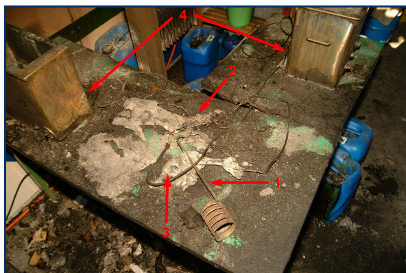
Fig. 3-36 1. Thermoplongeur. 2. Prise du thermoplongeur connectée à une multiprise elle-même raccordée au réseau. 3. Restes du bac en plastique. 4. Bacs en acier inox servant normalement à ce genre d'opération
