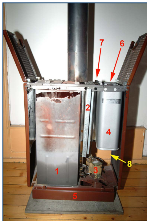
Fig. 3-15 Calorifère identique examiné dans un appartement voisin, avec : 1. foyer, 2. plaque de protection, 3. carburateur, 4. réservoir, 5. bac de rétention, 6 réglage du débit du réservoir, 7. réglage du débit du carburateur, 8. alimentation directe du carburateur
