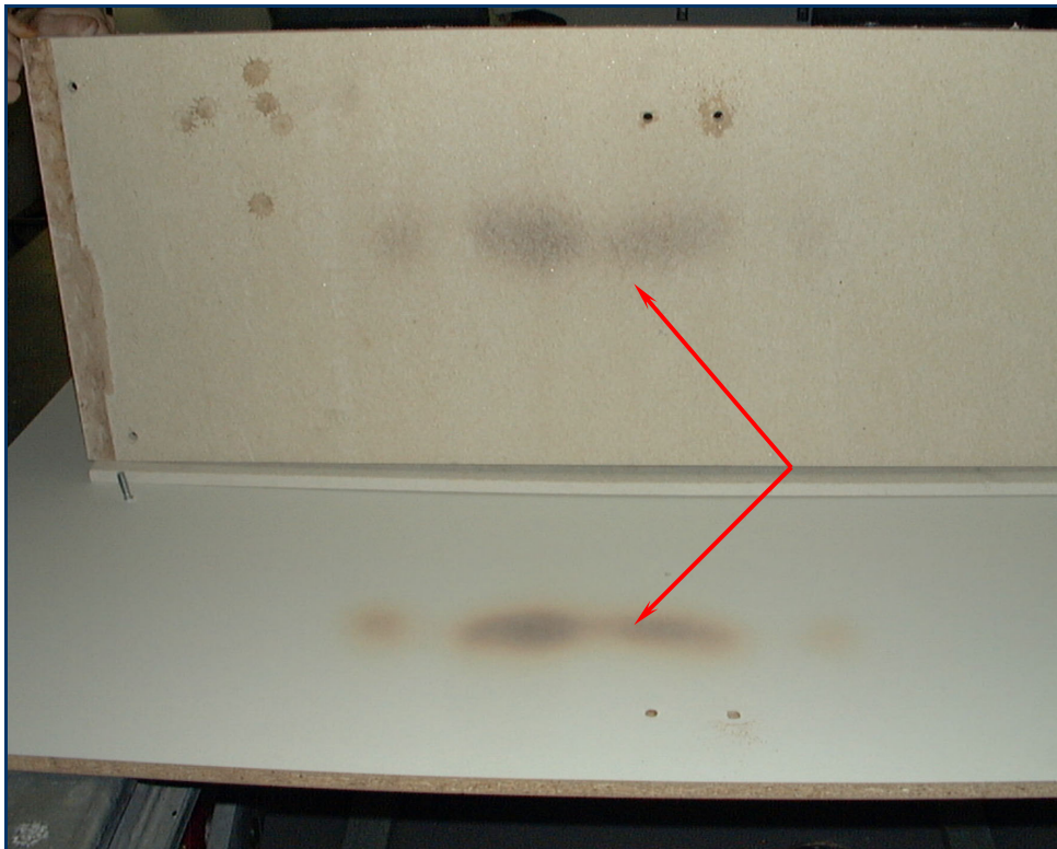
Fig. 2-33 Traces de calcinations visibles sur la face interne du panneau de particules stratifié, contre laquelle étaient appuyées les plaques de fibrociment (flèches rouges)
