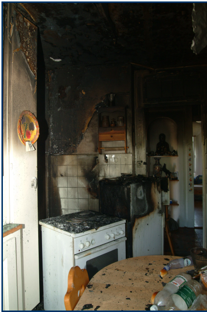
Fig. 3-32 Origine du sinistre située sur la face supérieure de la cuisinière
